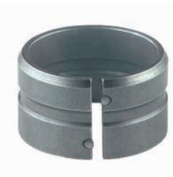
Douille de fixation EGPN4/EGPN4* avec ajustement serré et ergots
